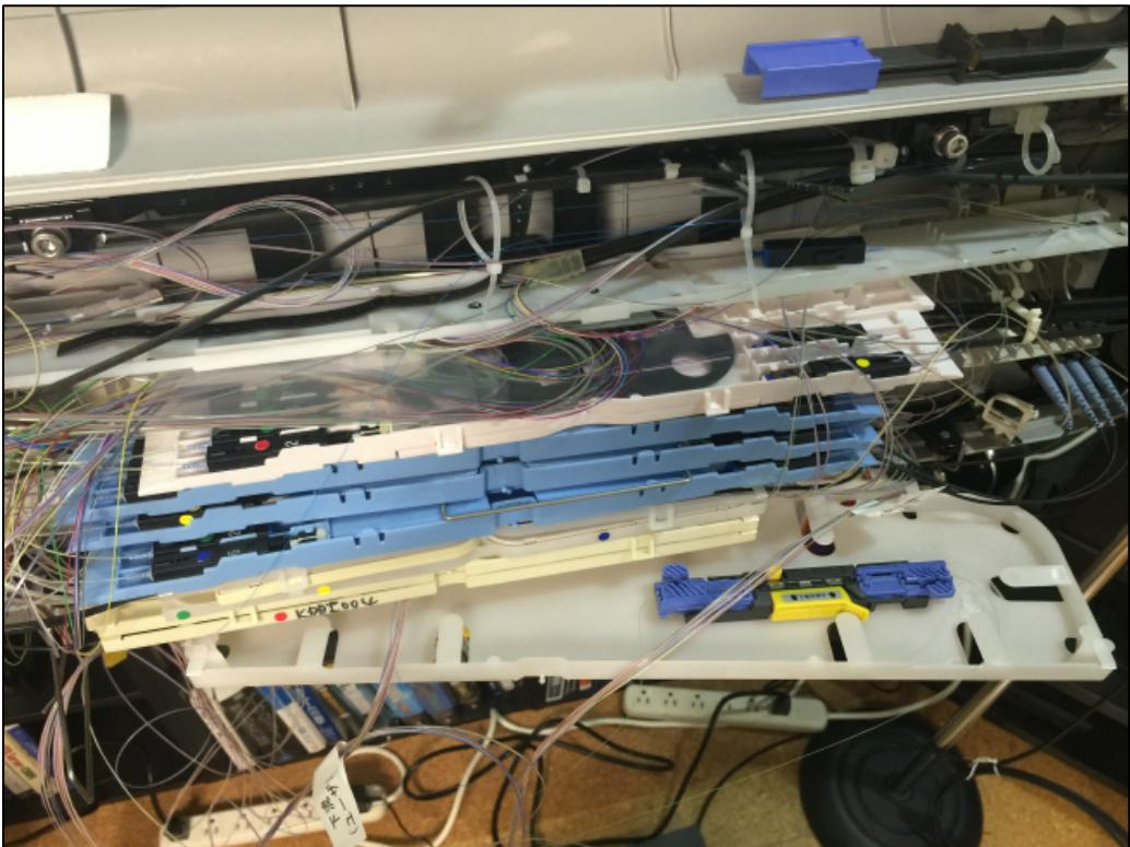
電柱上に吊つてある光ファイバと同様の「クロージャ」を分解した様子。
