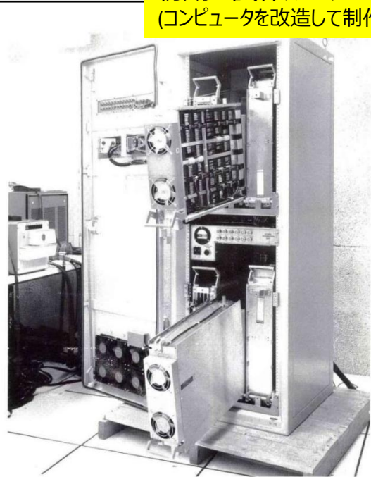
IMP (Interface Message Processor) ハネウェル製の耐衝撃型ミニコンピュータDDP-516をもとに開発され、初期のARPANETで各 サイト間のデータのやりとりを利用された。 (写真提供: フランク・ハート)
