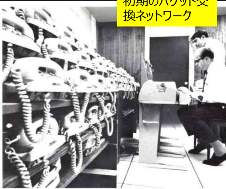
BBNの時分割システム 初期の時分割システムは、通常の電話回線を用いて企業や学校、研究所のコンピュータと 端末とを接続した。 (写真提供: BBN)
