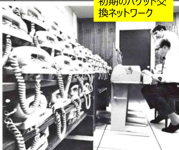
BBNの時分割システム 初期の時分割システムは、通常の電話回線を用いて企業や学校、研究所のコンピュータと 端末とを接続した。 (写真提供: BBN)
