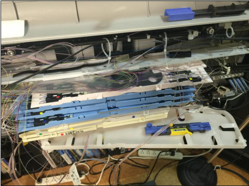
電柱上に吊ってある光ファイバと同様の「クロージャ」を分解した様子。
