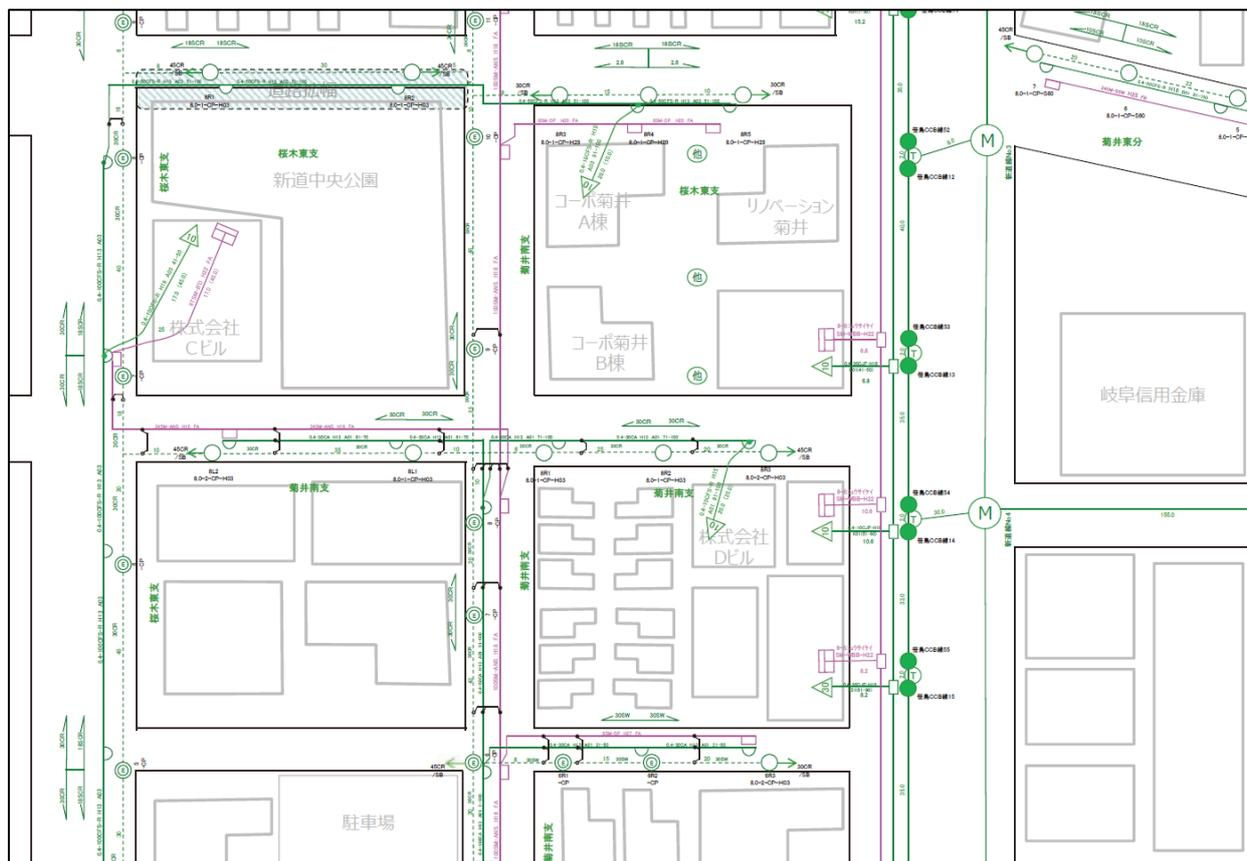
NTT 東日本の光ファイバ芯線管理システム「OPTOS」では、すべての加入光ファイバの地図上の配線と論理的な芯線の分岐・割当てを正確に管理している(写真は、模擬のマップである。公開資料「第9回 アクセスデザイン・コンテストの実施結果について」情報通信エンジニアリング協会雑誌より引用)
